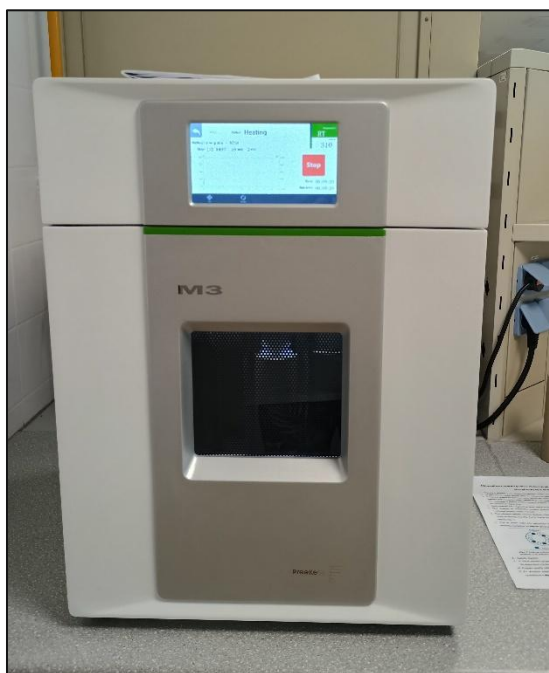
Obrázek 3: Nově instalované zařízení umožňující mikrovlnný rozklad vzorku
